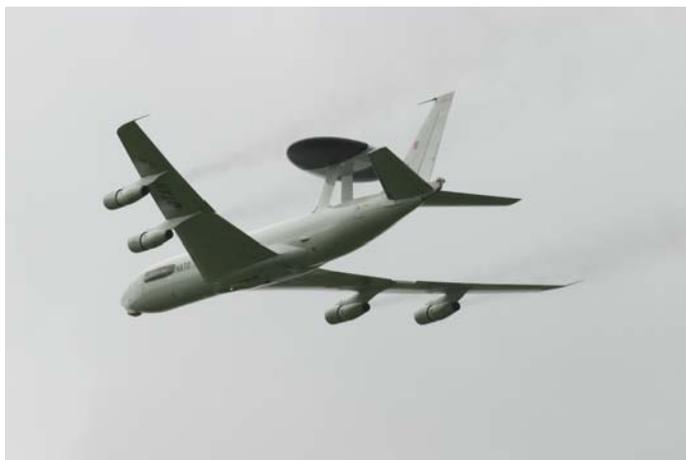
Das Airborne Warning and Control System (AWACS) ist ein radar-basiertes elektronisches System, das zur weitreichenden Luftraumaufklärung und als Einsatzleitzentrale eingesetzt wird.
